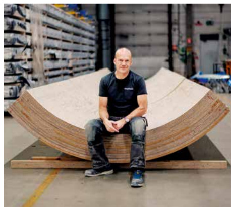
Sägeroboter haben die 16 bis 24 Meter langen Holzmodule zurechtgeschnitten. An ihnen wird eine 2-Megawatt-Windturbine befestigt, die etwa 500 schwedische Haushalte mit Strom versorgen kann.
